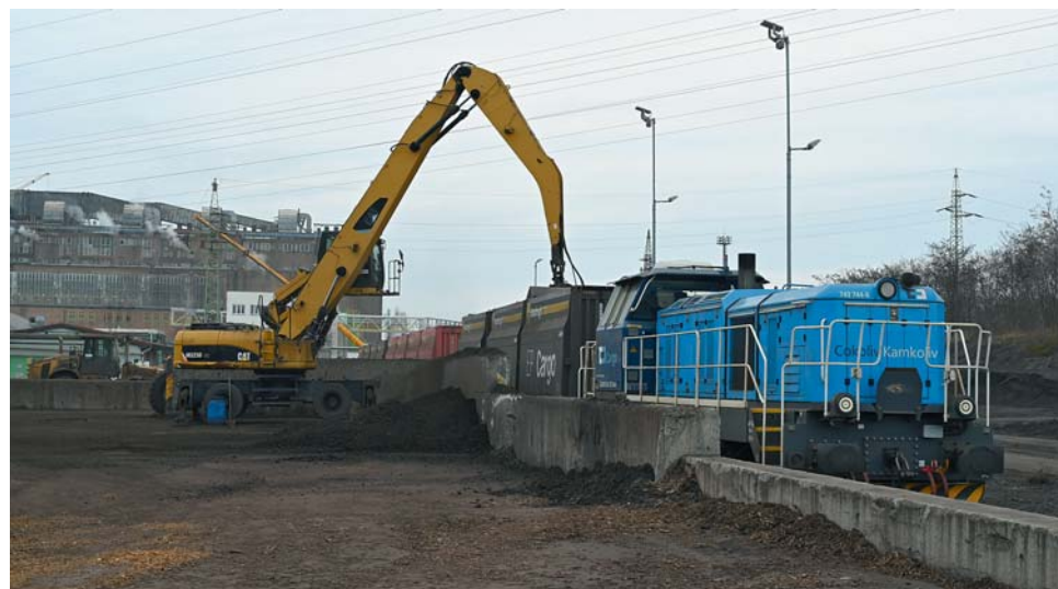
Teplárenskou vlečku tvoří jen jedna kolej, na které probíhá vykládka uhlí.
