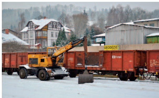
Vykládka tříděného uhlí je časově i technicky dosti náročná. Např. v Semilech je palivo z vozů řady Es vykládáno „drapákem“. (foto Michal Roh ml.)
