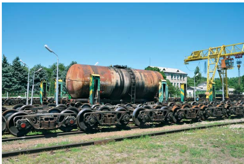
Převazovna vozů v pohraniční přechodové stanici Ungheni Foto: Michal Roh
