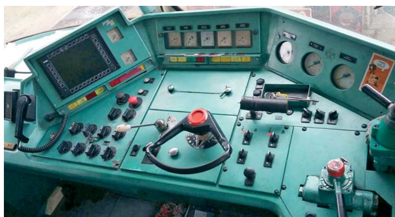
Stanoviště strojvedoucího na lokomotivě řady 230
