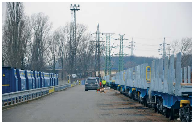
Zatímco na ploše vlevo již odpočívají kontejnery XXM, na koleji vpravo probíhají závěrečné práce spojené s montáží klanicových palet.
