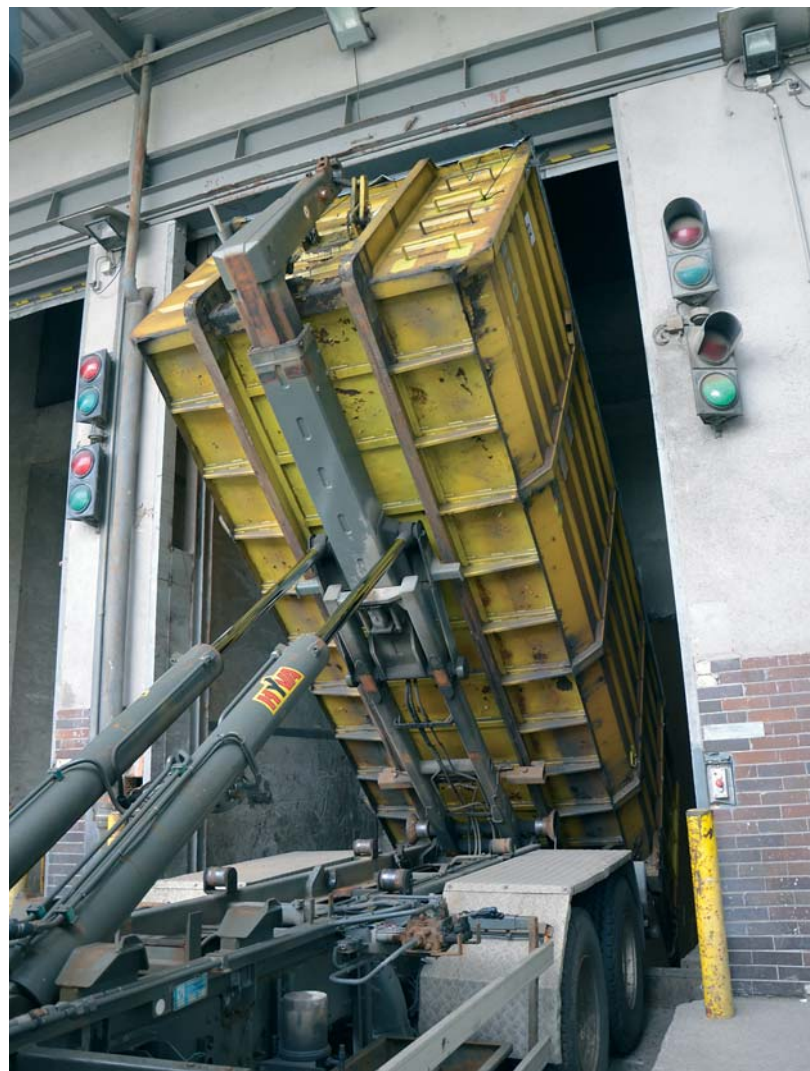
Vykládka komunálního odpadu v brněnské spalovně
