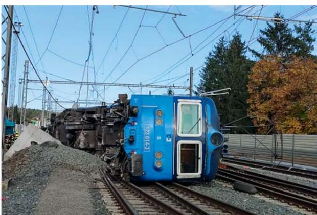
das Ausfahrtsignal L4 und Einfahrt auf das Sackgleis Nr. 4a. Dabei entgleisten das Triebfahrzeug und zwei mit Benzol beladene Kesselwagen. Die entgleisten Fahrzeuge kippten anschließend auf die Seite. Bei dem Unfall wurden zwei Arbeitnehmer der ČD Cargo verletzt und es entstand erheblicher Schaden sowohl an den Fahrzeugen als auch an den Eisenbahnoberbauten.
