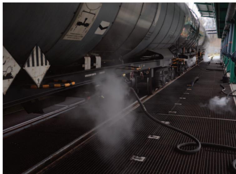
Vor dem Entladen müssen die Ventile der Wagen aufgewärmt werden.
