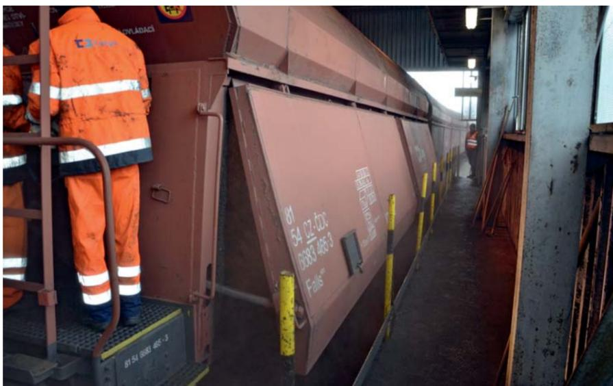
Entladung von Wagen der Falls-Klasse im Tiefbunker des Heizkraftwerks Krnov
