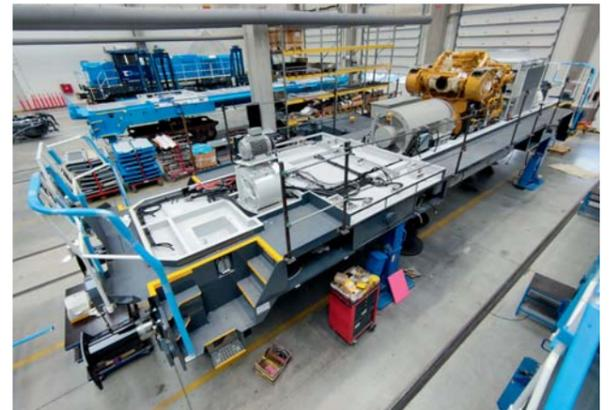
Montage der Lokomotive der Serie 742.71, d.h. der Einbau des Motorgenerators zusammen mit dem Kühlblock des Verbrennungsmotors, im Produktionswerk von CZ LOKO in Jihlava
