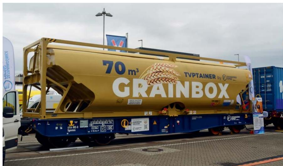
Wagen der Reihe Sgmmns 41' mit Selbstentlader-Container TVPtainer für Getreidetransport
