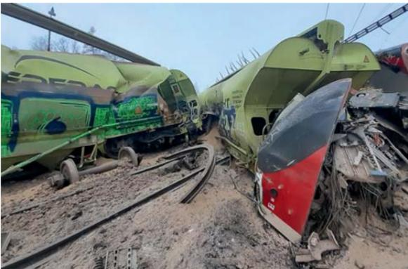
• Am 9. Dezember 2023 kam es in Zábřeh na Moravě (Strecke Přerov – Česká Třebová) bei der Fahrt eines gezogenen Rangierteils des Beförderers ČD Cargo am Herzstück der Weiche Nr. 21 zum Entgleisen eines Waggons der Faccs-Reihe mit allen Achse, worauf dieser umstürzte. Beim AE kam es zu keinen Gesundheitsschäden, es entstand jedoch größerer Schaden am umgestürzten Fahrzeug und am Bahnoberbau.
