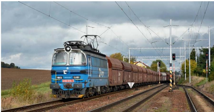
Ein Ganzzug mit Kohle für das Heizwerk in České Budějovice passiert den Bahnhof Blovice. Für den Transport von Zügen aus dem Sokolovbecken werden am häufigsten die „Lamino“-Lokomotiven der Reihen 230 oder 240 eingesetzt, sowie neuerdings auch die „Blech“-Lokomotiven der Reihe 242. FOTO: MICHAL ROH JR.
