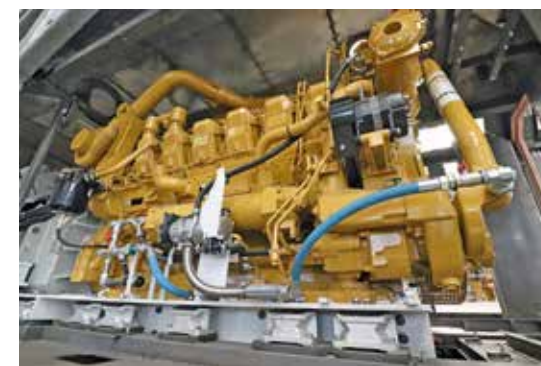
Spalovací motor Caterpillar 3512C HD vyhovuje emisní normě škodlivin Evropské unie Stage IIIA. CZ LOKO
