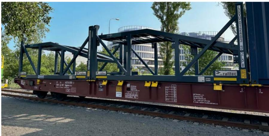
Ein 80-Fuß-Wagen der Reihe Sggnss 80´ mit interessanten „Containern“ für den Autotransport in der Ausstellung des Frachtführers METTRANS Rail
