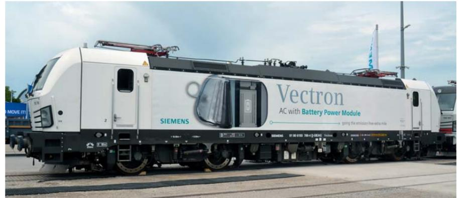
Duale Siemens Vectron-Zugmaschine mit batteriegestütztem Hilfsantrieb
