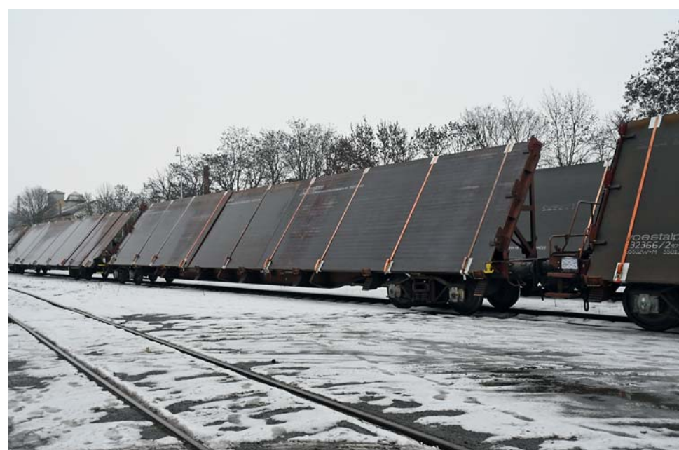
Detailní pohled na vůz řady Uais ložený plechy o rozměrech až 8 200 x 3 300 mm
