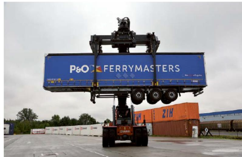
**TERMINÁL.** V areálu ČD DUSS v Lovosicích jsou kromě kontejnerů manipulovány i silniční návěsy.
