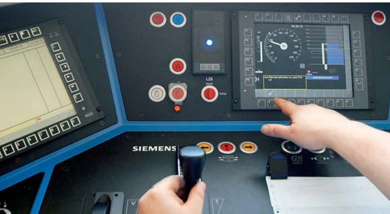
Potvrzení přechodu z ETCS na zabezpečovač LS na lokomotivě Vectron Foto: Petr Říha
