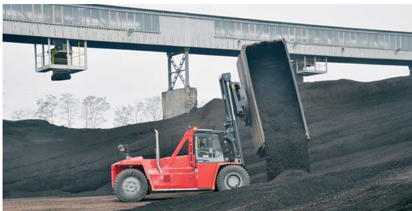
Vykládka InnoFreightů v areálu plzeňské teplárny
