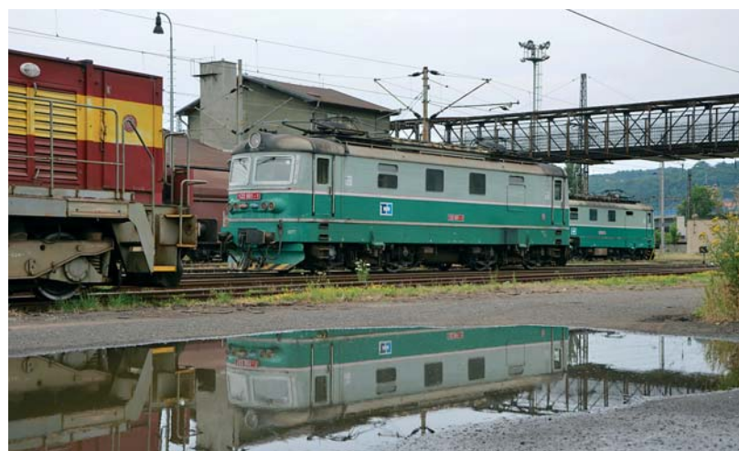
Lokomotiv řady 122 bylo v roce 1967 v plzeňské Škodovce vyrobeno celkem 55 kusů a dodnes je můžeme spatřit v čele značného počtu nákladních vlaků v severních a středních Čechách. Na snímku Michala Roha ml. z Prahy vidíme dvě lokomotivy odstavené ve stanici Děčín-východ. Nebo tu jsou odstavené lokomotivy tři?
