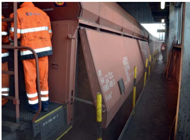
Vykládka vozů řady Falls na hlubinném zásobníku v teplárně Krnov
