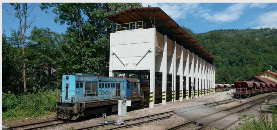
Lokomotivy 742.147 + 742.453 posunují v sobotu 27. července 2024 s výsypnými vozy řady Faccs u na-kládky na vlečce kamenolomu v Liticích nad Orlicí. FOTO: TOMÁŠ SÁGNER
