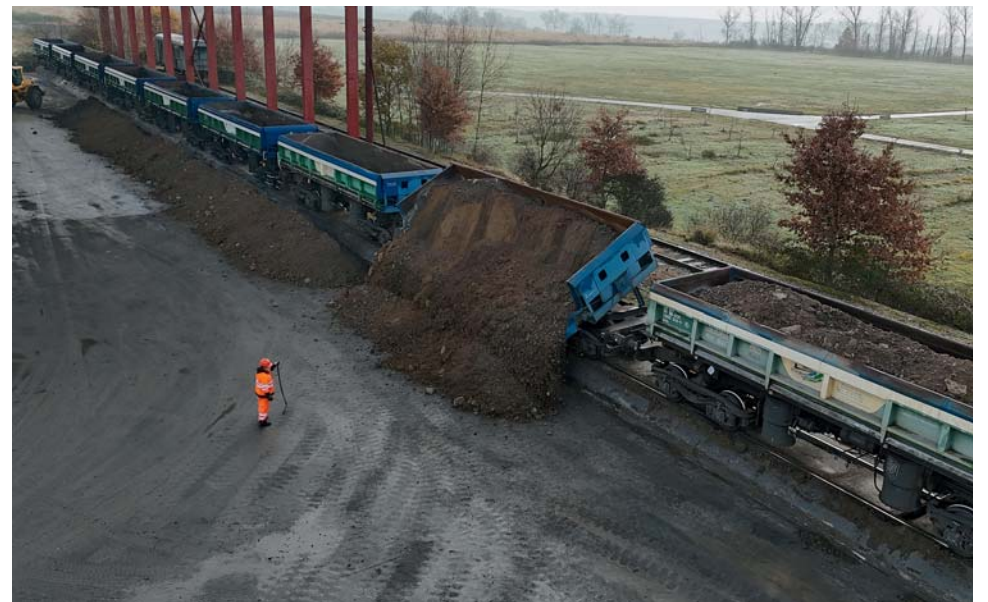
Pro zkušené pracovníky PP České Budějovice nepředstavuje vykládka zeminy z vozů Dumpcar na vlečce v Dívčicích žádný problém. FOTO: MICHAL ROH
