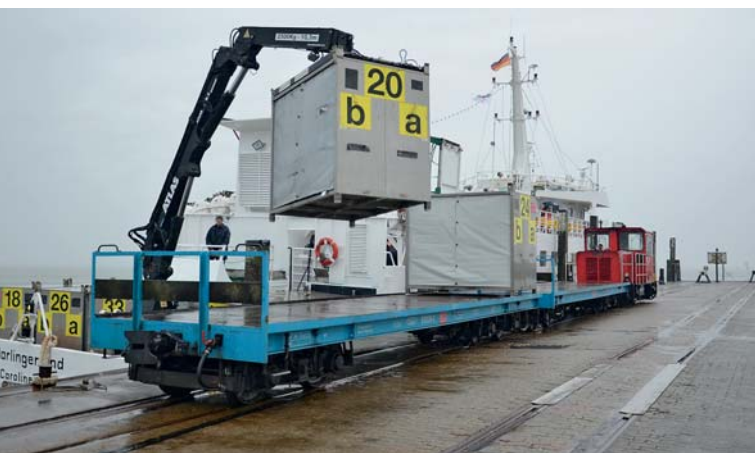
Překládka kontejnerů se zavazadly z vlaku na trajektovou loď Harlingerland na západním přístavním molu
