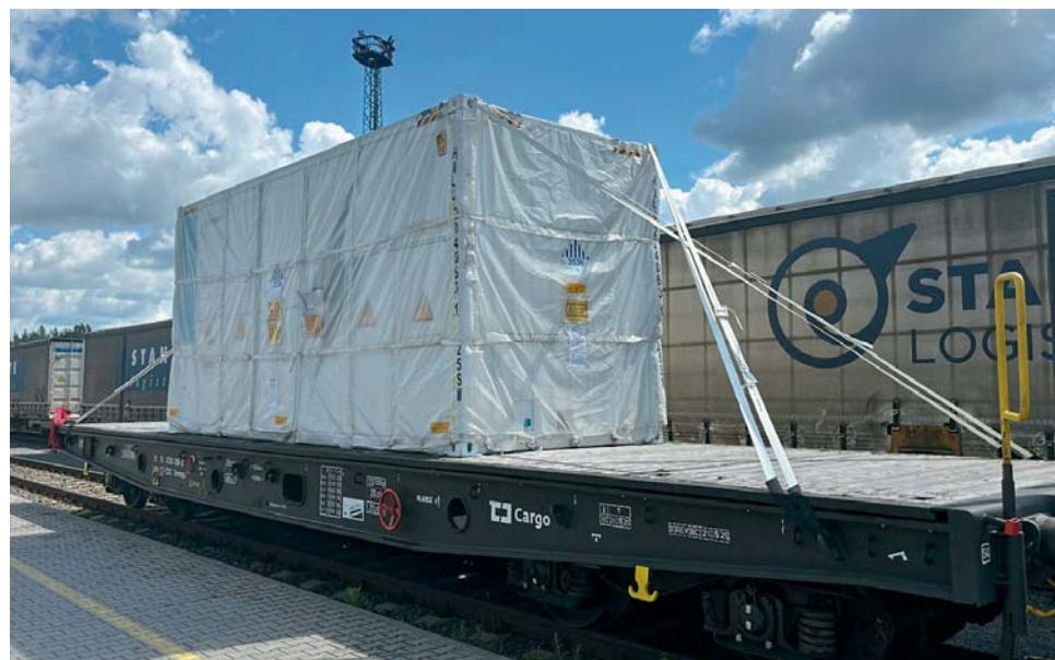
Pro přepravu bateriových úložišť byly využity vozy řady Smmps ČD Cargo.
