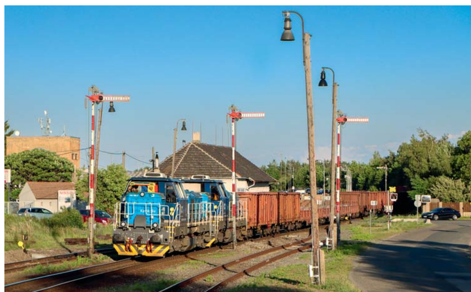
.... které po úvratí ve stanici Hostivice stanulo v čele vlaku. Na snímku z pozdního odpoledne vlak projíždí stanicí Jeneč dosud vybavenou mechanickými návěstidly. FOTO: JAROSLAV MĚŘÍNSKÝ
