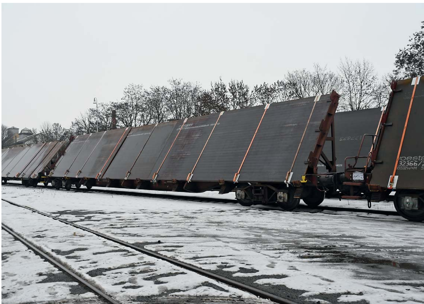
Detailansicht eines Wagens der Baureihe Uais, beladen mit Blechen mit Abmessungen von bis zu 8 200 x 3 300 mm
